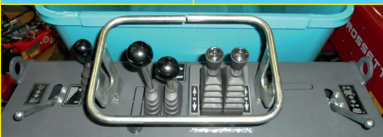
**Control levers for the machine travelling and manoeuvring. / Fortbewegungssteuerung und Maschinenbetätigung. / Рычаги управления движением и маневрированием.**
